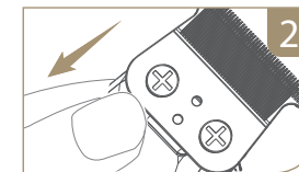
Wyregulować ostrze, delikatnie przesuwając je na odległość 0 mm
